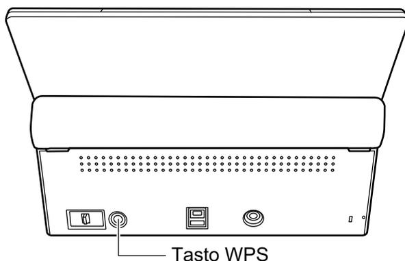
⇒ ScanSnap si collega al punto di accesso wireless e la spia dell'indicatore Wi-Fi si illumina in blu.
